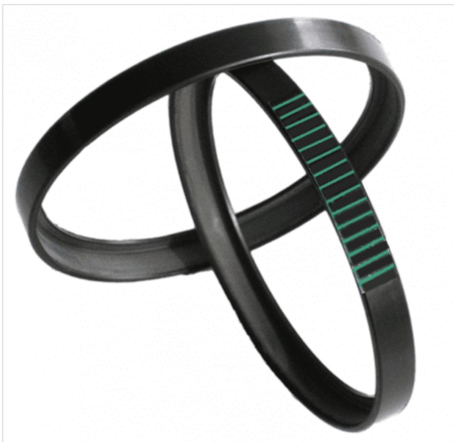
Hutchinson développe des bagues magnétiques standards ou sur-mesure, composées de caoutchouc magnétique adhérent sur un insert métallique. Les propriétés élastiques du caoutchouc, combinées à une bonne adhésion caoutchouc-métal, assurent de bonnes performances dans des environnements extrêmes. Nous développons des bagues magnétiques sur-mesure pour qu'elles s'adaptent parfaitement à différentes technologies de capteurs telles que l'effet Hall, l'AMR ou le GMR...
