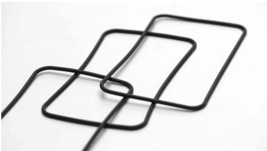
Notre joint haute température assure une parfaite étanchéité à l'air aux deux extrémités du refroidisseur d'air suralimenté. Les niveaux de température de fonctionnement (jusqu'à 230°C) et le recyclage de gaz d'échappement à PH2 ont nécessité le développement de mélanges fluorés spécifiques par les experts du Groupe. Notre joint est homologué par les principaux acteurs de la gestion thermique moteur.
