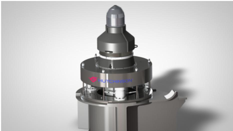
Nuestros conectores altamente resistentes para las plataformas TLP permiten amarrar el soporte flotante de la plataforma TLP a los pilotes hincados en la plantilla de cimentación. Unen los diferentes segmentos de tendón entre sí y ofrecen al tendón una capacidad portante y una estanqueidad elevadas.
