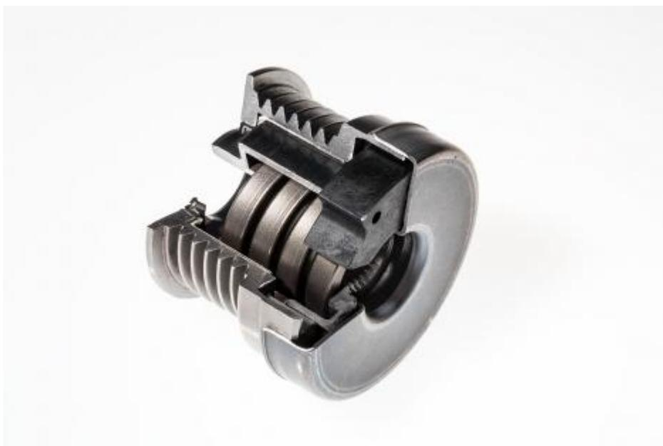
Nuestra solución combina una polea de desacoplamiento del alternador (DAP) y una correa elástica para transmitir la potencia desde el motor hasta los diferentes elementos de la parte frontal de la transmisión. Permite simplificar la arquitectura de dicha parte frontal, ya que gracias a ella se pueden eliminar uno o más rodillos, así como el tensor automático.
