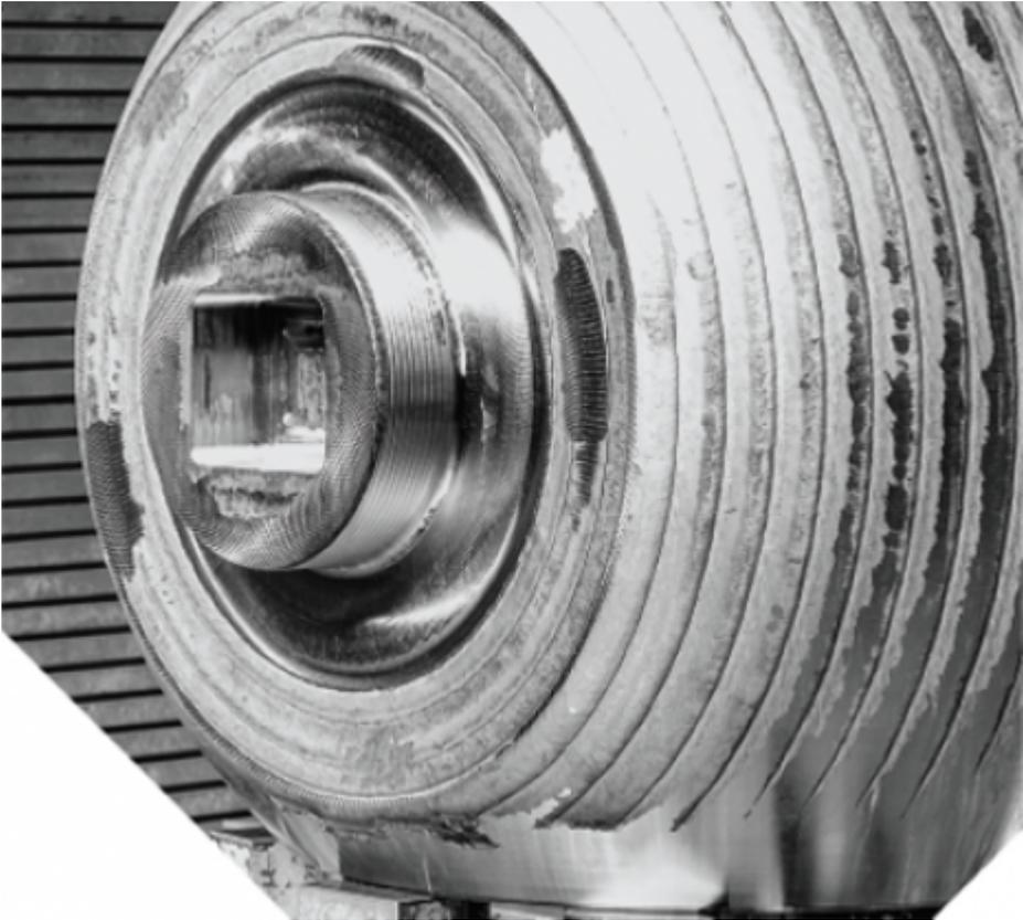
Plattierte Kugeln von der Konstruktion bis zur Fertigung, nach den Spezifikationen des Schweißverfahrens, hergestellt nach den Anforderungen unserer weltweiten Kunden. Die Schweißauflage wird durch Aufbringen von zwei oder mehreren Schichten Schutzmaterial auf eine Grundmaterialoberfläche, in der Regel Kohlenstoffstahl, erhalten. Typischerweise Inconel oder Edelstahl F316, chemisch geeignet, um Korrosion in Gegenwart von aggressiven Flüssigkeiten oder Gasen zu widerstehen.
