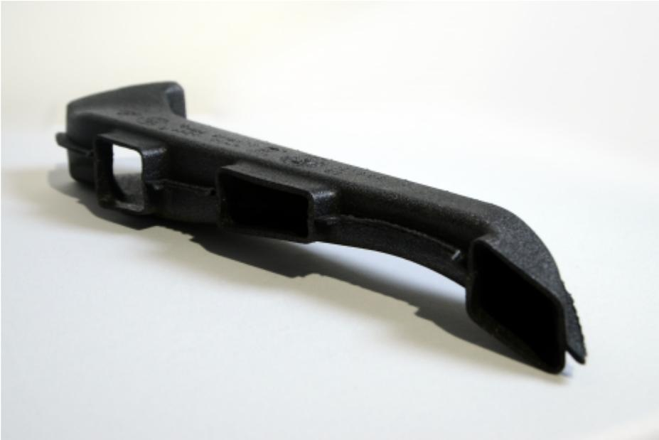
Unsere Twinsheet-Luftkanäle aus Schaum stellen für HLK-Systeme eine optimierte Luftzirkulation im ganzen Fahrzeug sicher. Sie sind nicht einmal halb so schwer wie herkömmliche Kunststoff-Luftkanäle und bieten eine außergewöhnlich gute Schall- und Wärmedämmung. Das weiche Material erleichtert den Zusammenbau und beugt bei Unfällen Schäden vor. Wir sind in der Lage, innerhalb kürzester Fristen für unsere Kunden Prototypen anzufertigen.
